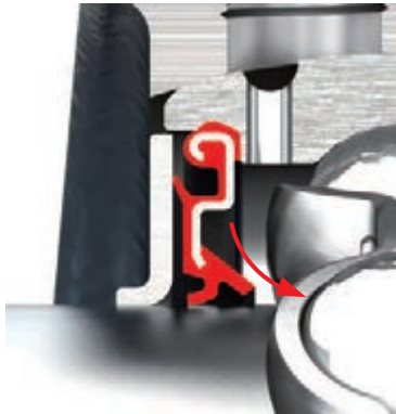
图 1.3 轴承组件的密封结构
