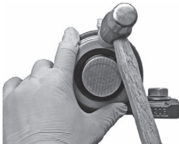
图 14.12 钢板盖的安装
