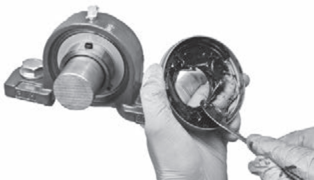
图 14.11 在防尘盖的密封圈唇部和内部空间填装润滑脂
