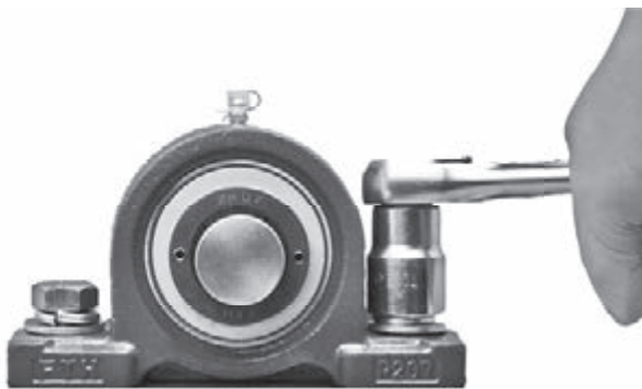
图 14.4 将轴承组件固定在底座上
