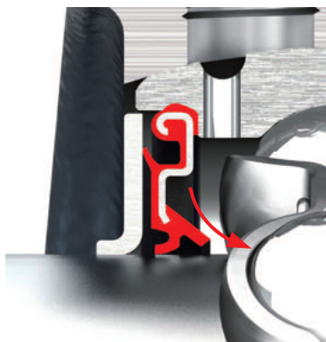
図 1.3 軸受ユニットの密封構造
