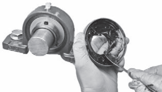
図 14.11 カバーのシールリップと内部空間にグリースを詰める
