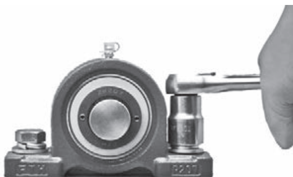
図 14.4 軸受ユニットを機台に固定
