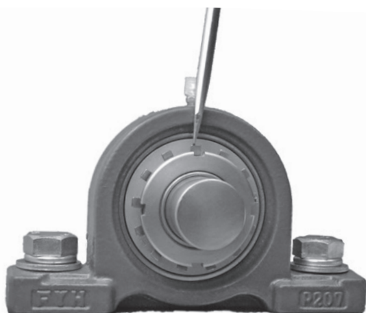
図 14.8 座金の爪を折り曲げる (ロックナットの緩み止め)
