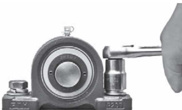
図 14.4 軸受ユニットを機台に固定
