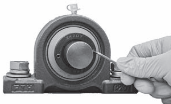
図 14.9 Z ロックスリーブの締め付け
