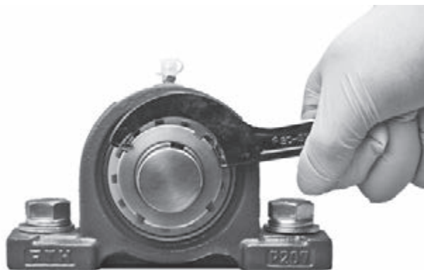
図 14.7 ロックナットの締め付け
