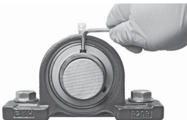
図 14.5 止めねじの締め付け
