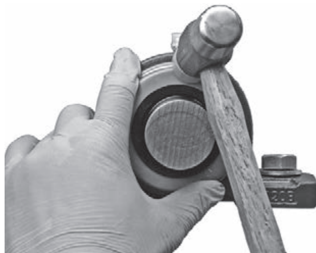
図 14.12 鋼板カバーの取付け
