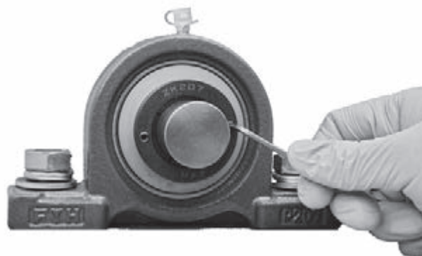
图14.9 Z LOCK套筒的锁紧
