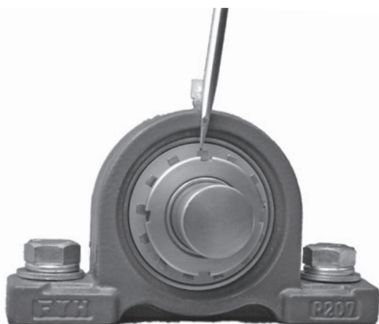
图 14.8 折弯垫圈的爪 (锁紧螺母的防松)
