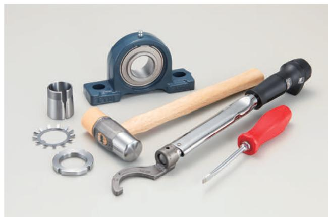
従来のUKテーパ穴軸受ユニットは、取り付けにたくさんの工具が必要です。ロックナットはカタログのトルク表を参照しながらトルクレンチで締め付けないとなりません。アダプタの締め過ぎは、軸受の内部すきまを小さくしてしまい軸受の寿命に影響を与えます。
