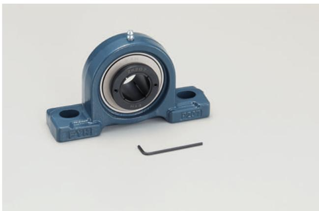
ZKユニットは、六角レンチを使用し、手で止めねじを締め付けます。それにより軸受の内部すきまに影響を与えることなく、従来のアダプタより強く締め付けることが可能です。
