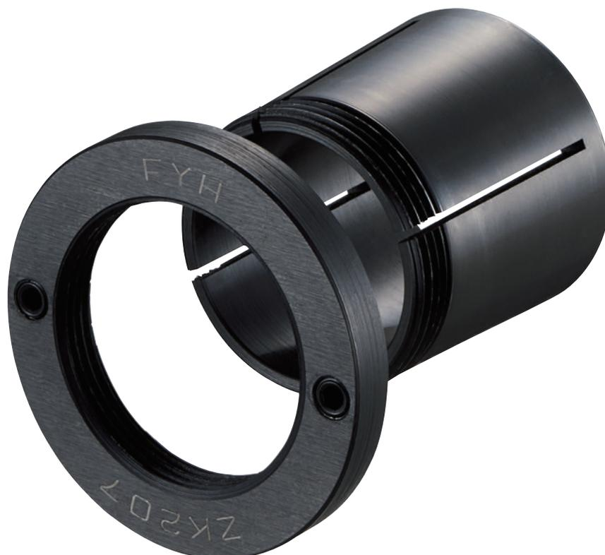
ZKは、革命的なロックシステムであるZロック（特許取得済）の玉軸受バージョンです。新シリーズのZKは、現行のUKテーパ穴軸受とアダプタに替わる、FYHオリジナルのZロックスリーブを組み合わせたユニットです。従来のUKユニットは軸受とアダプタが別々で出荷されていましたが、ZKは組み立て済みで工場から出荷されますので、箱から出してすぐに使用可能です。ZKの取り付けは画期的で、六角レンチ1本で2箇所止めねじを手で締め付けるだけです。トルクレンチも必要なく締めすぎによる軸受内部のすきまへの影響もありません。
