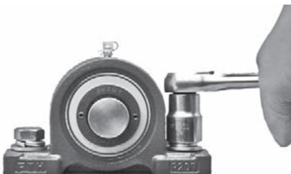
図 14.4 軸受ユニットを機台に固定
