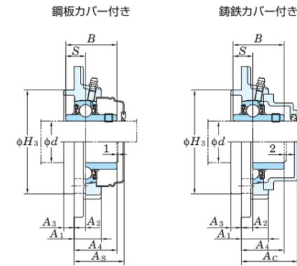
印ろう外径の寸法差 ( $\Delta H_{3s}$ )、取付面から球状軸受座中心までの距離の寸法差 ( $\Delta A_{2s}$ )、ボルト穴の位置度公差 (X) および印ろうの円周振れ公差 (Y)
