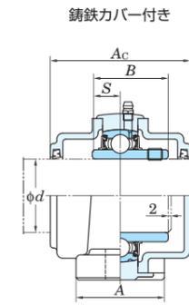
取付底面から球状軸受座中心までの距離の寸法差 (ΔHs) 単位 mm
