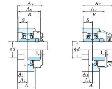
取付面から球状軸受座中心までの距離の寸法差 (ΔA2s) およびボルト穴中心間の距離の寸法差 (ΔJs)
