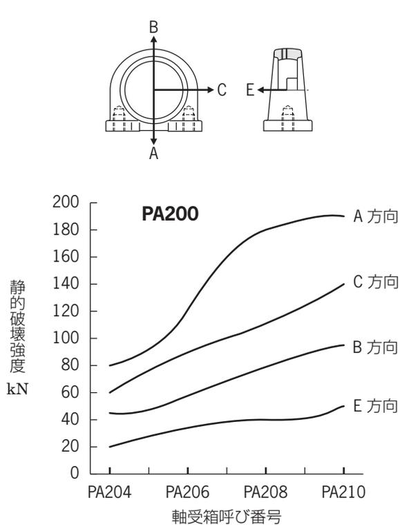
図 8.3 狭幅ピロー形軸受箱(PA)の静的破壊強度
