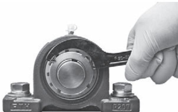
図 14.7 ロックナットの締め付け
