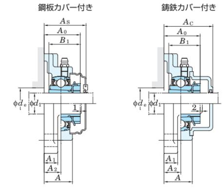
取付面から球状軸受座中心までの距離の寸法差(ΔA<sub>2s</sub>)およびボルト穴の位置公差(X)
