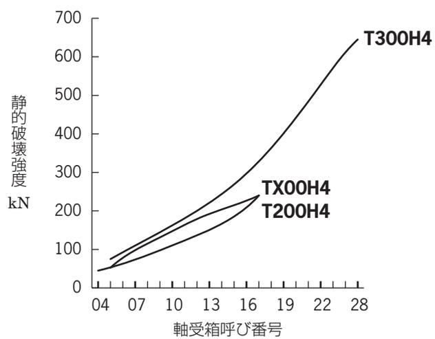
図 8.11 球状黒鉛鑄鉄製テークアップ形軸受箱(T<sub>H4</sub>)の静的破壊強度
