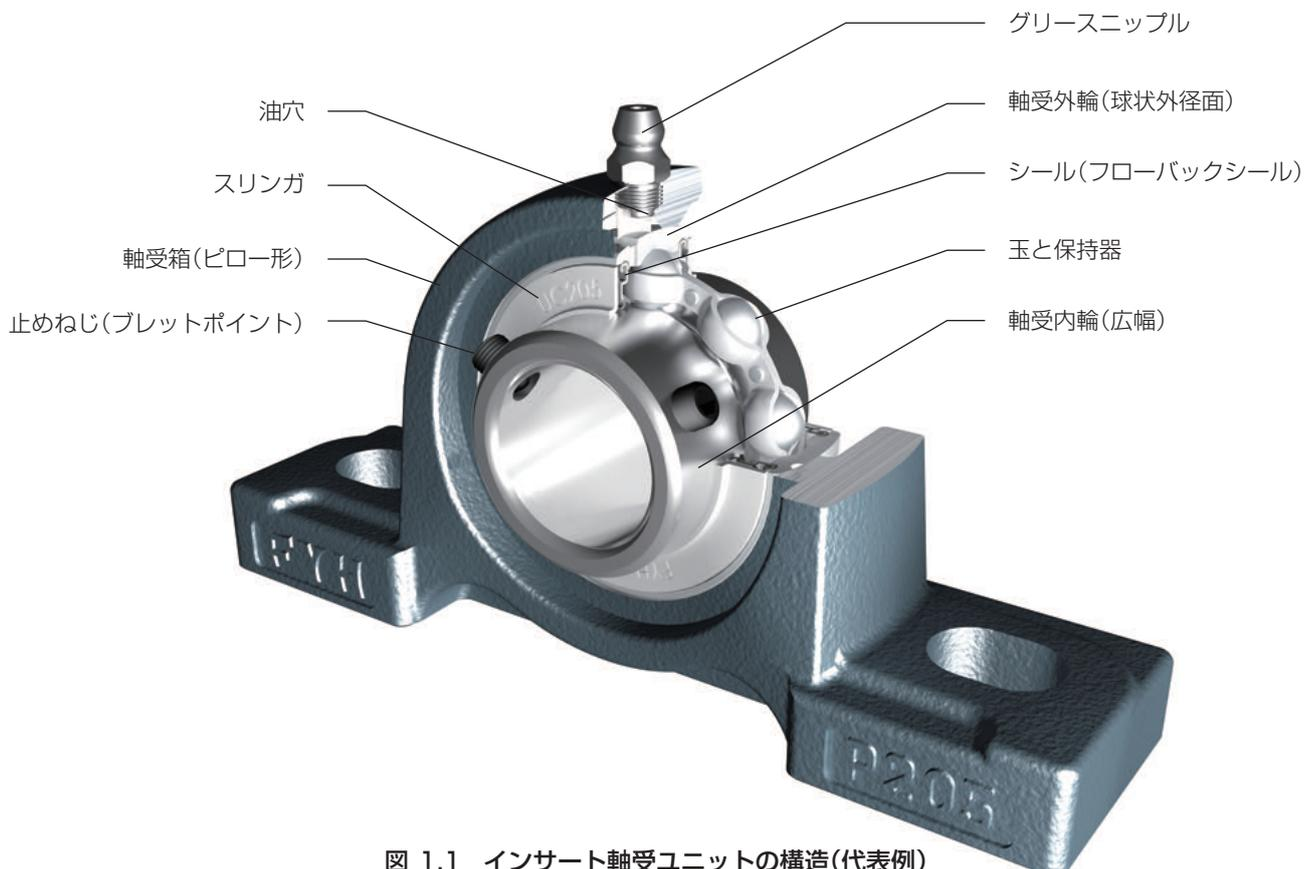
図 1.1 インサート軸受ユニットの構造(代表例)
