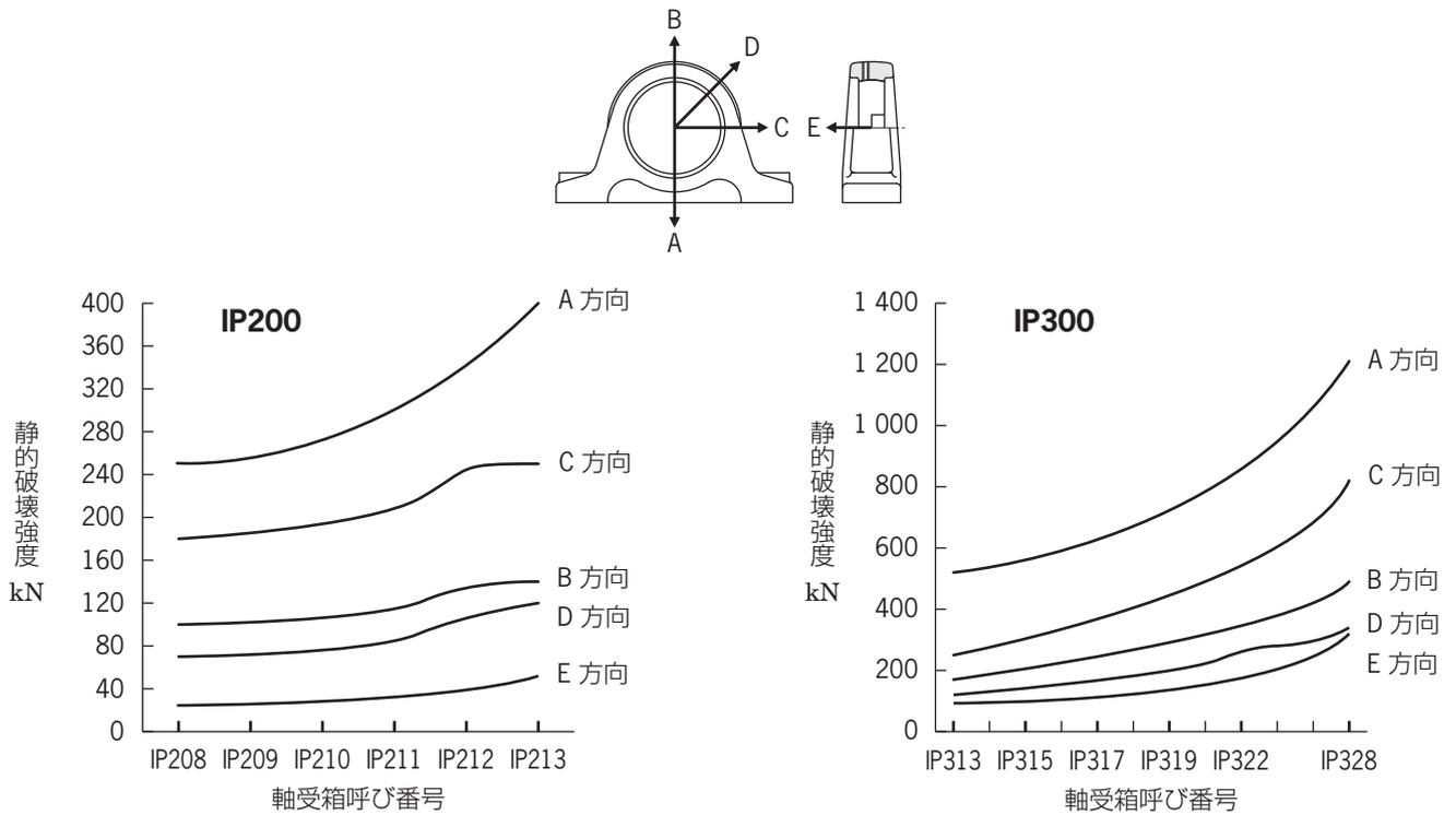
図 8.2 厚肉ピロー形軸受箱(IP)の静的破壊強度
