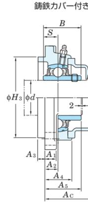
印ろう外径の寸法差( $\Delta_{F3s}$ )、取付面から球状軸受座中心までの距離の寸法差( $\Delta_{A2s}$ )、ボルト穴の位置公差(X)および印ろうの円周振れ公差(Y)
