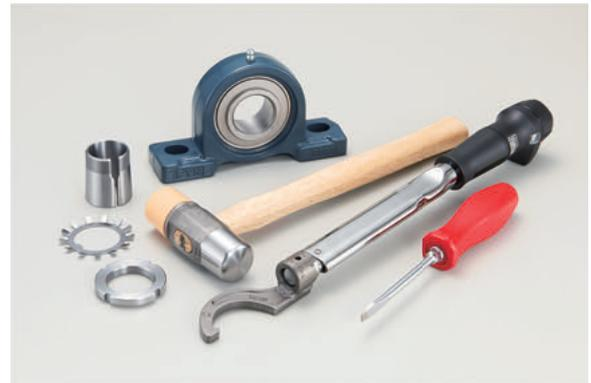
従来のUKテーパ穴軸受ユニットは、取り付けにたくさんの工具が必要です。ロックナットはカタログのトルク表を参照しながらトルクレンチで締め付けないといけません。アダプタの締め過ぎは、軸受の内部すきまを小さくしてしまい軸受の寿命に影響を与えます。
