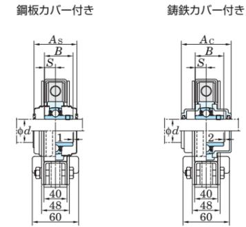
取付底面から球状軸受座中心までの距離の寸法差 ( $\Delta m_s$ )およびボルト穴中心間の距離の寸法差 ( $\Delta m_e$ )
