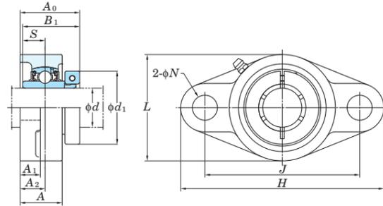
取付面から球状軸受座中心までの距離の寸法差 (ΔA2s)およびボルト穴の位置度公差(X)
