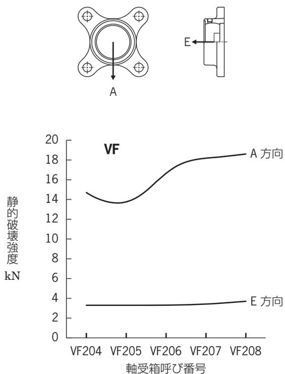
図 8.15 プラスチック製軸受箱(VF)の静的破壊強度
