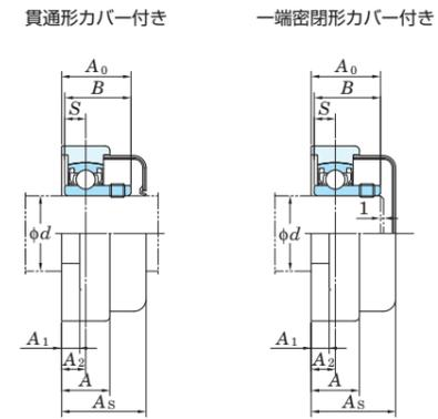
取付面から球状軸受座中心までの距離の寸法差 ( $\Delta A_2$ )およびボルト穴中心間の距離の寸法差 ( $\Delta J_2$ )
