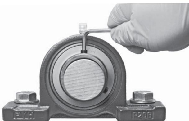
図 14.5 止めねじの締め付け
