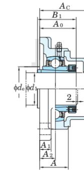
取付面から球状軸受座中心までの距離の寸法差(ΔA<sub>2s</sub>)およびボルト穴の位置公差(X)
