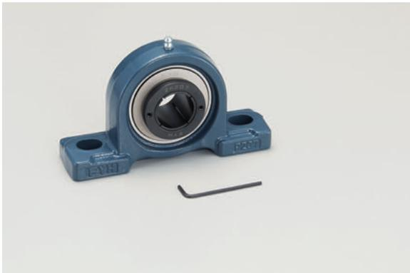
ZKユニットは、六角レンチを使用し、手で止めねじを締め付けます。それにより軸受の内部すきまに影響を与ることなく、従来のアダプタより強く締め付けることが可能です。
