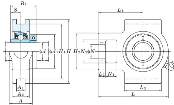
溝幅の寸法差( $\Delta A_{1s}$ )、両溝底間の距離の寸法差( $\Delta H_{1s}$ )および両溝側面の対称度公差(X)
