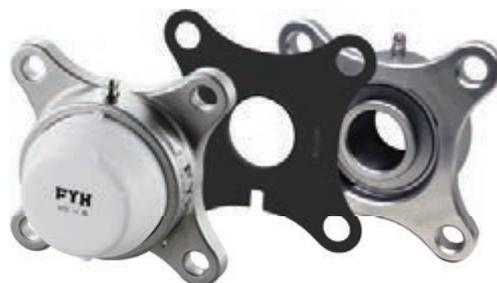
鋼板の表面にニトリルゴムを使用したドレンスロットの無いモデルは防塵用の設計に適しており、本製品の主な使用用途として、汚れがユニットの裏側に達する場所で、粉砕機・スクリーコンベア・肥料散布機・融雪剤スプレッダーや農業用途などに適しています。
