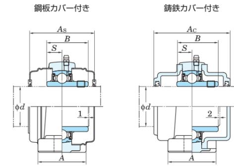
取付底面から球状軸受座中心までの距離の寸法差 (ΔHs) 単位 mm
