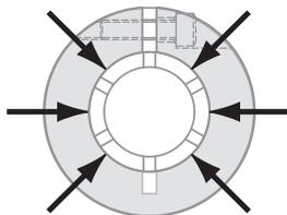
FYH NC形軸受は軸を360°全周から均等に締め付けて固定出来ます。締め付けによる軸受内輪の変形は小さく、よりよい運転と長寿命をもたらします。NC形軸受用同心固定輪は軸を傷つけないように設計されており、一般の六角レンチで簡単に素早く取り付けることが出来ます。NC形軸受は止めねじタイプ、偏心固定輪タイプと入れ替えることが出来ます。他のタイプとの主な特徴は以下のとおりです。
