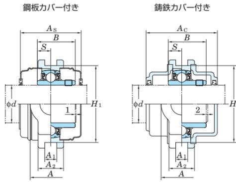
溝幅の寸法差(ΔA1s)、両溝底間の距離の寸法差(ΔH1s)および両溝側面の対称度公差(X)
