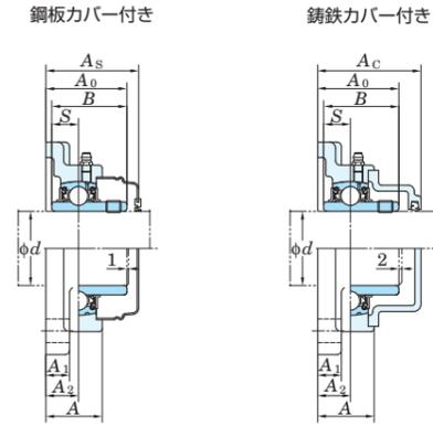
取付面から球状軸受座中心までの距離の寸法差(ΔA2s)およびボルト穴の位置公差(X)
