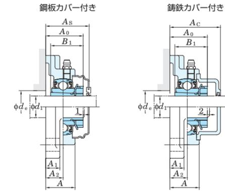
取付面から球状軸受座中心までの距離の寸法差(ΔA<sub>2a</sub>)およびボルト穴の位置公差(X)
