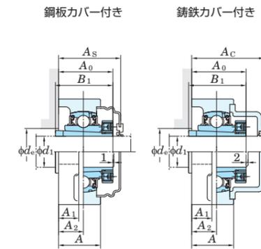
取付面から球状軸受座中心までの距離の寸差(ΔA<sub>2s</sub>)およびボルト穴の位置公差(X) 単位 mm
