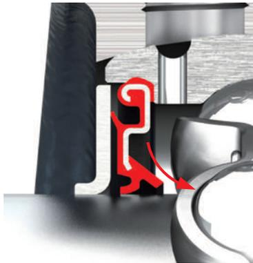
図 1.3 軸受ユニットの密封構造
