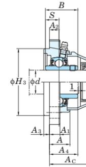
印ろう外径の寸法差( $\Delta H_{3s}$ )、ボルト穴の位置公差(X)および印ろうの円周振れ公差(Y)
