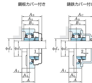
取付面から球状軸受座中心までの距離の寸法差(ΔA<sub>2s</sub>)およびボルト穴の位置公差(X) 単位 mm
