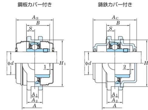
溝幅の寸法差(ΔA1s)、両溝底間の距離の寸法差(ΔH1s)および両溝側面の対称度公差(X)
