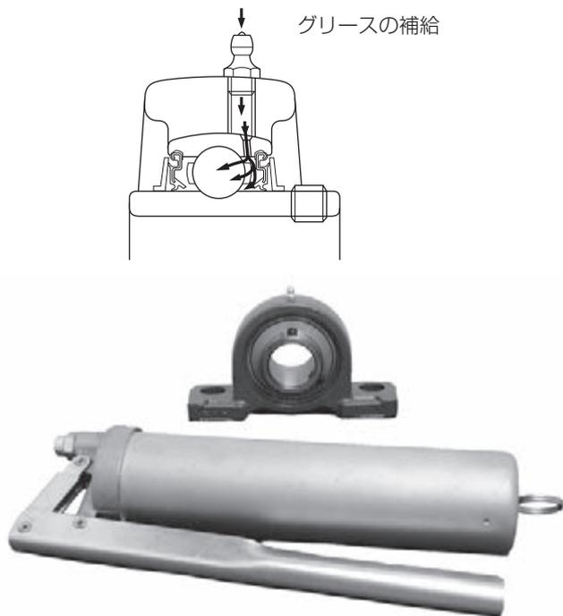
図 14.13 軸受ユニットへのグリースの補給
