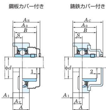
取付面から球状軸受座中心までの距離の寸法差(ΔA2s)およびボルト穴の位置公差(X) 単位 mm
