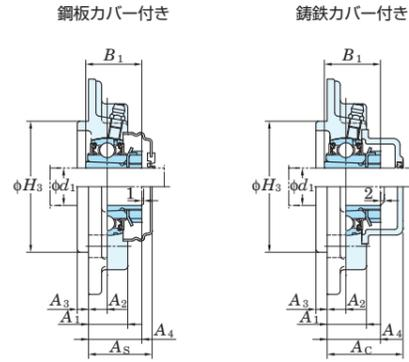
印ろう外径の寸法差(ΔH<sub>3s</sub>)、取付面から球状軸受座中心までの距離の寸法差(ΔA<sub>2s</sub>)、ボルト穴の位置公差(X)および印ろうの円周振れ公差(Y)
