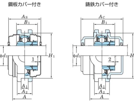
溝幅の寸法差(ΔA<sub>1s</sub>)、両溝底間の距離の寸法差(ΔH<sub>1s</sub>)および両溝側面の対称度公差(X)
