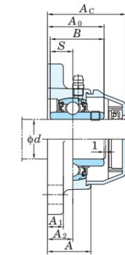
取付面から球状軸受座中心までの距離の寸法差 (ΔA2s) およびボルト穴の位置度公差 (X)
