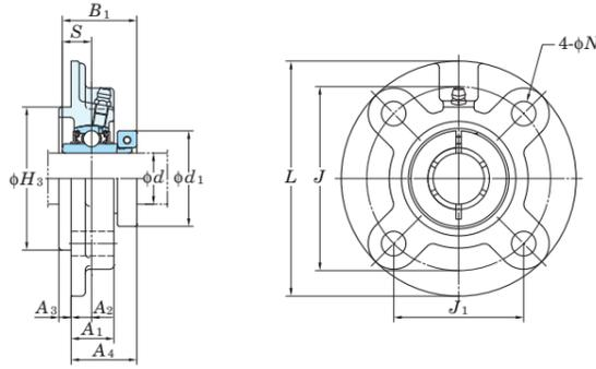
印ろう外径の寸法差 ( $\Delta H_{fs}$ )、取付面から球状軸受座中心までの距離の寸法差 ( $\Delta A_{2s}$ )、ボルト穴の位置度公差 (X) および印ろうの円周振れ公差 (Y)
