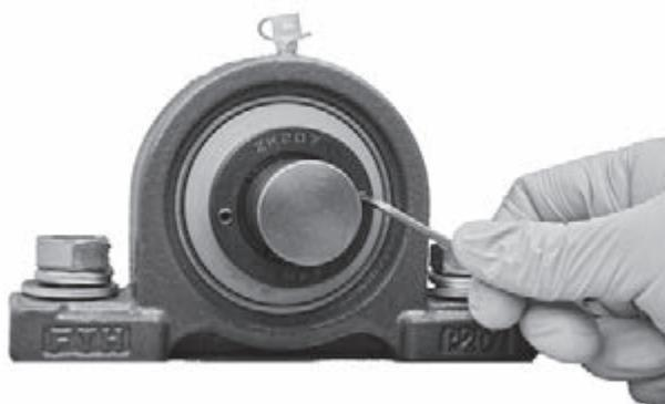
図 14.9 Z ロックスリーブの締め付け
