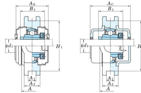
溝幅の寸法差(ΔA<sub>1s</sub>)、両溝底間の距離の寸法差(ΔH<sub>1s</sub>)および両溝側面の対称度公差(X)
