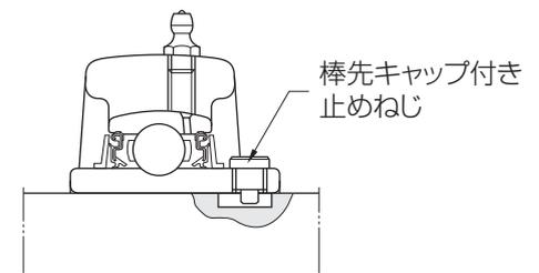
図 9.1 棒先キャップ付き止めねじを用いて自由側を使用する方法
