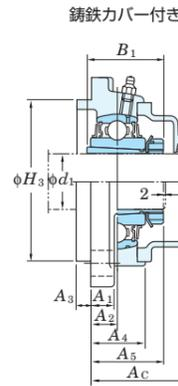
印ろう外径の寸法差(ΔF<sub>3s</sub>)、取付面から球状軸受座中心までの距離の寸法差(ΔA<sub>2s</sub>)、ボルト穴の位置公差(X)および印ろうの円周振れ公差(Y)
