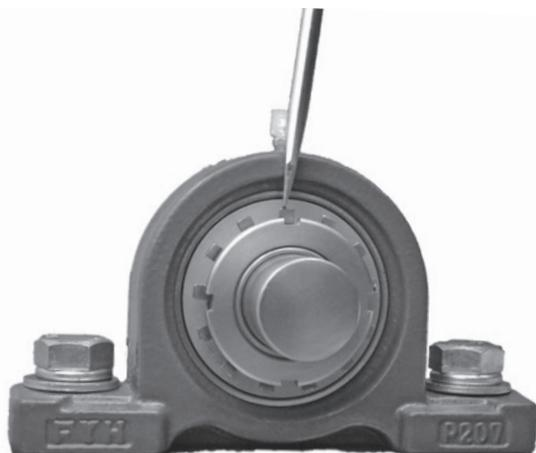
図 14.8 座金の爪を折り曲げる
