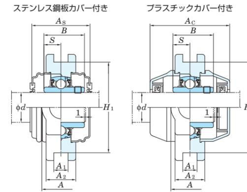
溝幅の寸法差 ( $\Delta A_{1s}$ )、両溝底間の距離の寸法差 ( $\Delta H_{1s}$ ) および両溝側面の対称度公差 (X)
