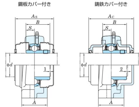
取付底面から球状軸受座中心までの距離の寸法差 ( $\Delta H_s$ )、ボルト穴中心間の距離の寸法差 ( $\Delta J_s$ ) およびボルト穴径の寸法差 ( $\Delta N_s$ )
