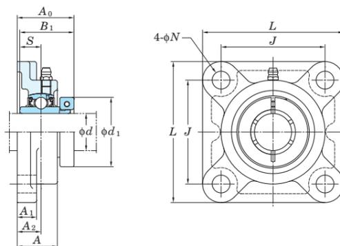
取付面から球状軸受座中心までの距離の寸法差 ( $\Delta A_{2s}$ )およびボルト穴の位置公差(X)
